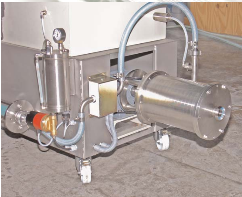
MÜGROMIX+ mit axialem Mischkopf Typ MÜ3 • Alle wartungsrelevanten Komponenten sind einfach und schnell zu erreichen.
